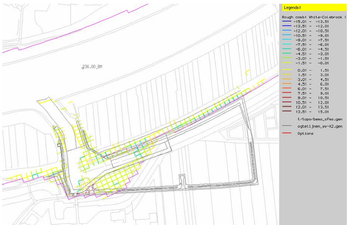
Figuur 5 2D-ruwheidsverschil (Nikuradse m), ontwerp waha2_v4 versus waalwijk_v00
