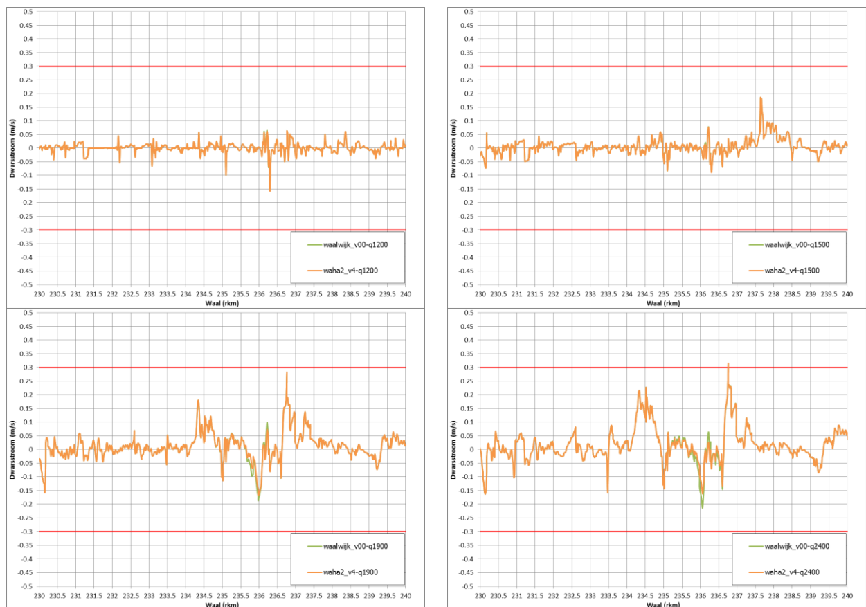
Figuur 11 dwarsstroming referentiesituatie (groene lijn) en 2017-ontwerp (oranje lijn)
