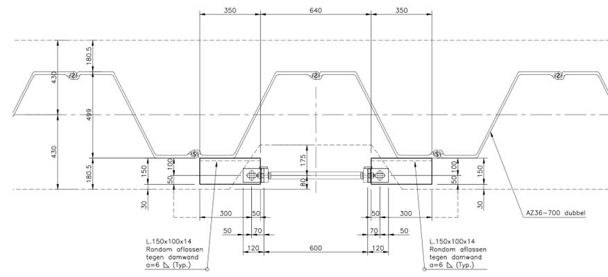
HORIZONTALE DOORSNEDE C-C
