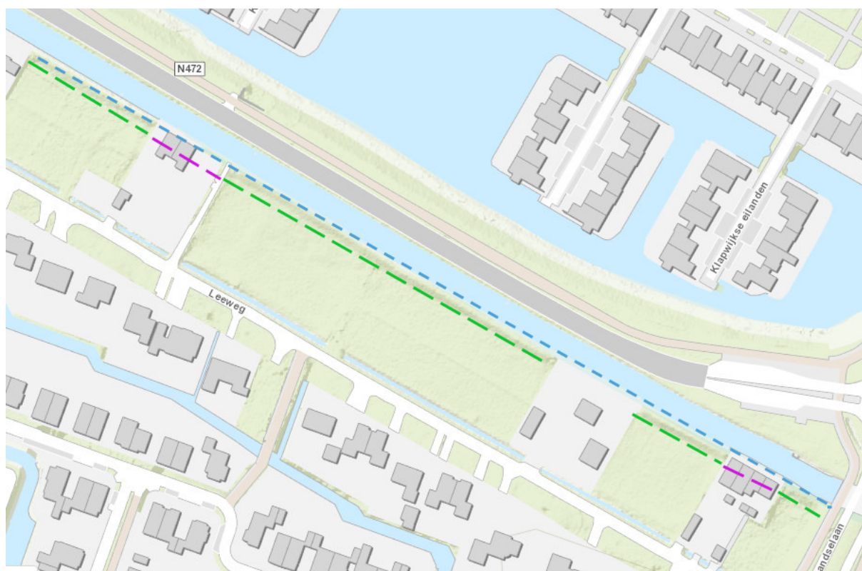
Figuur 3: De blauwe lijn geeft de locatie van vak 18 aan, de groene lijn is de kade waar een nieuwe beschoeiing wordt geplaatst, ter plekke van de paarse lijnen wordt een kade met een keerwand aangelegd.
