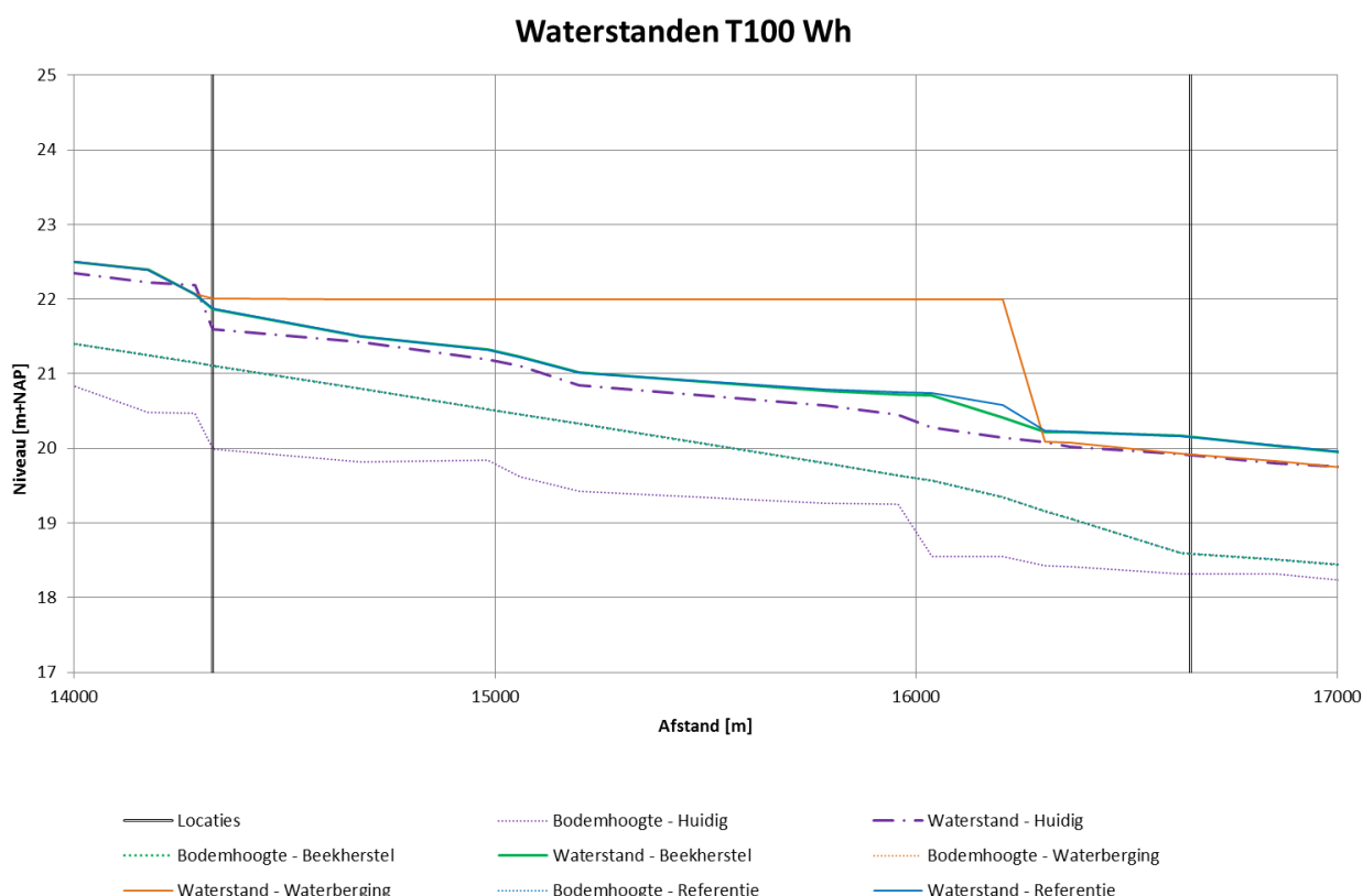
Figuur 2 Lengteprofiel berekende waterstanden T100Wh waterbergingsgebied
