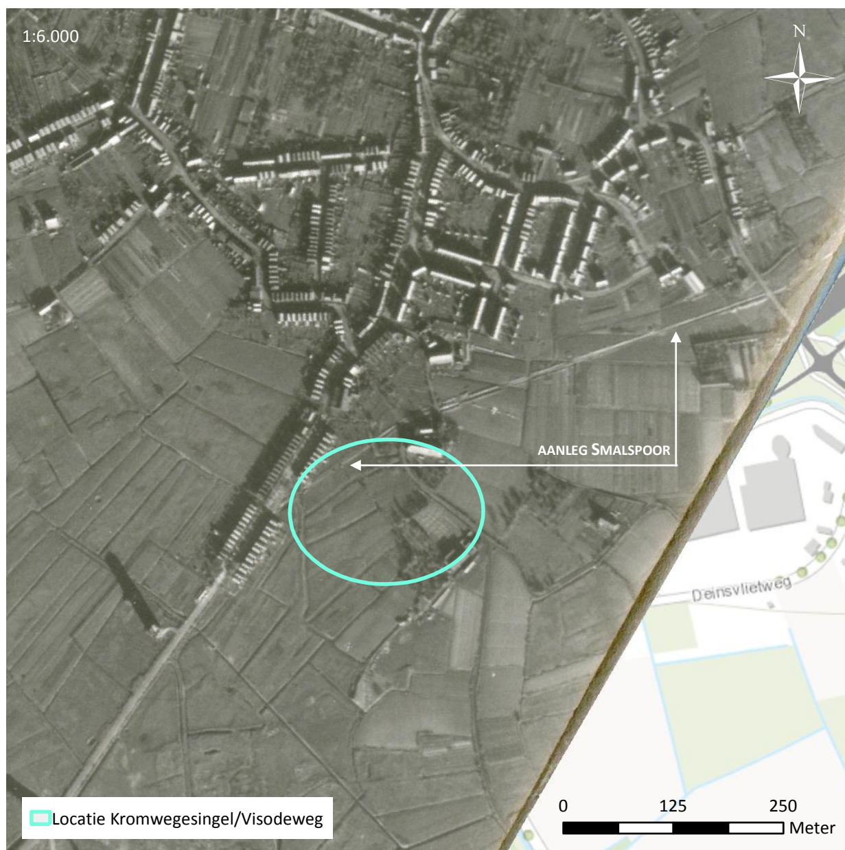
Figuur 27: Het onderzoeksgebied op luchtfotoframennummer 4066, sortie E-461 daterende van 3 november 1943. Er zijn werkzaamheden in verband met de aanleg van een smalspoorbaan in het onderzoeksgebied zichtbaar.
