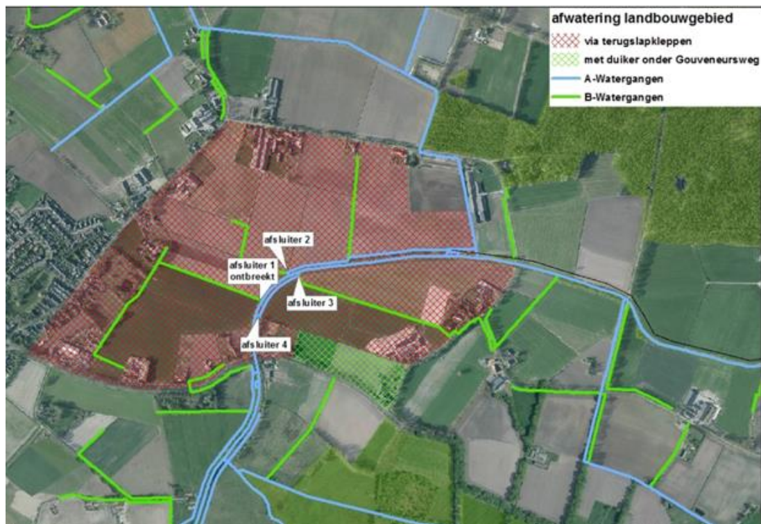
Figuur 6: Afwatering landbouwgebied tussen stuw 211A en stuw 211B
