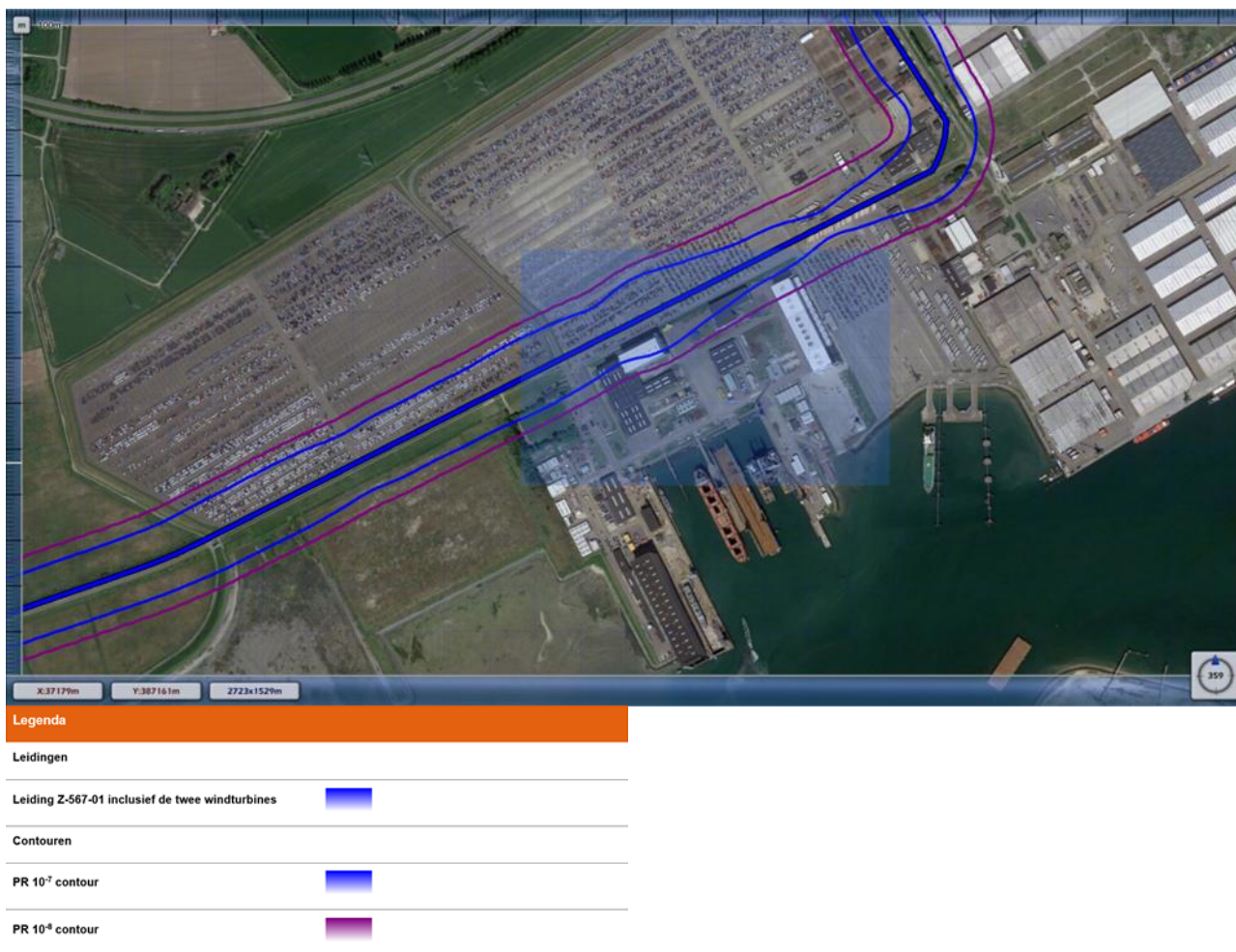
Figuur 6: De PR-contouren van leiding Z-567-01 inclusief de twee windturbines
