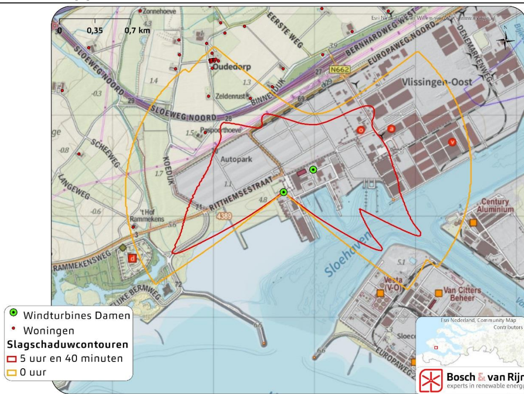
Figuur 5 De 5:40u en 0u slagschaduwcontouren van de bovenvariant. Hierbij zijn ook woningen van derden weergegeven.
