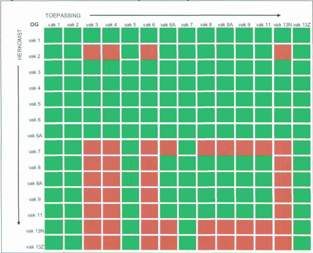
Figuur 9.2: Grondstromenmatrix voor toepassing van ondergrond als bovengrond
