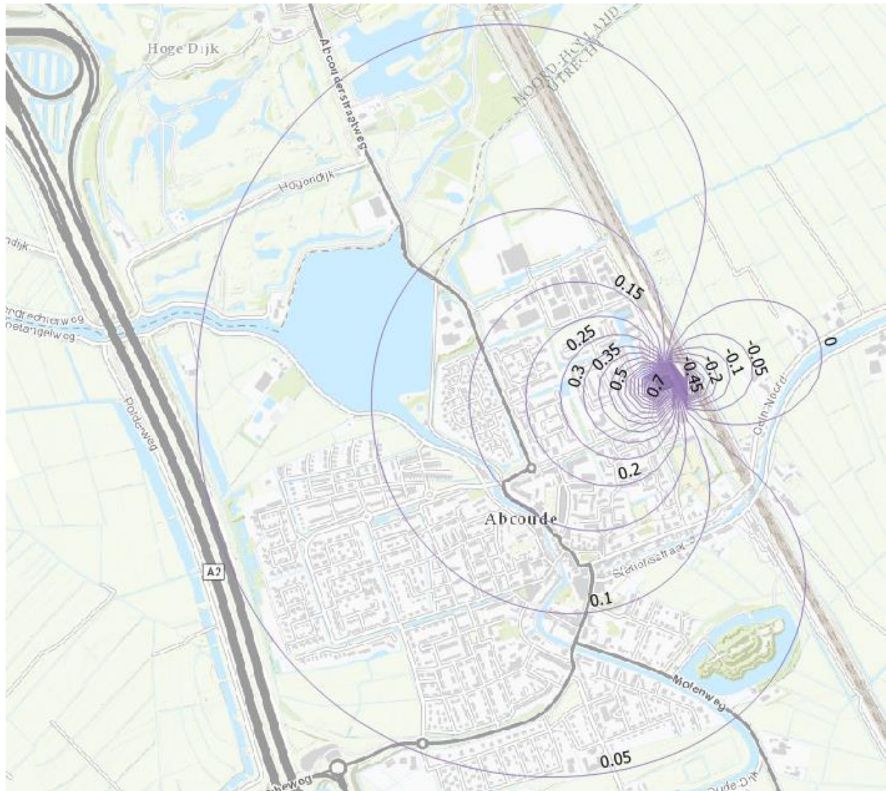
Figuur 5: Projectlocatie en het invloedsgebied van de spanningsbemaling (5 centimeter verlagingscontour)
