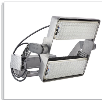
ArenaVision LED gen2 BVP515 schijnwerperarmatuur, uitvoering met 2 lichtmodules en geïntegreerde driverdoos
