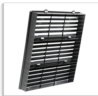
ZVP520 L-A90 Externe louvre van nul candela voor asymmetrische optieken, 90°
