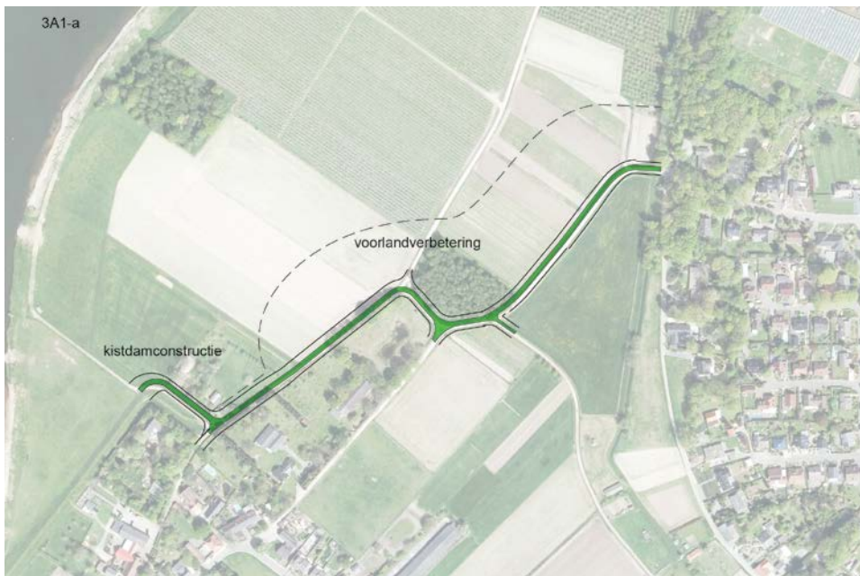
Figuur 8 Ruimtebeslag 3A1-a (stippellijn is indicatie voorlandverbetering)
