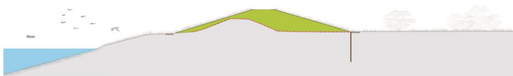
Figuur 13 Indicatief dwarsprofiel voor dijkvakken 3 en 4
