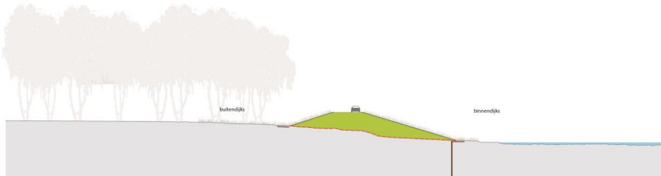
Figuur 15 Indicatief dwarsprofiel dijkvak 5
