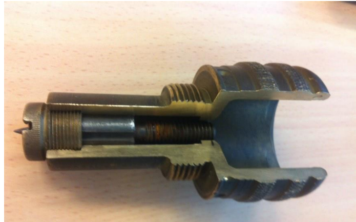
Afbeelding 10- Een mechanische ontsteker met ingedrongen/vastzittende slagpin.
