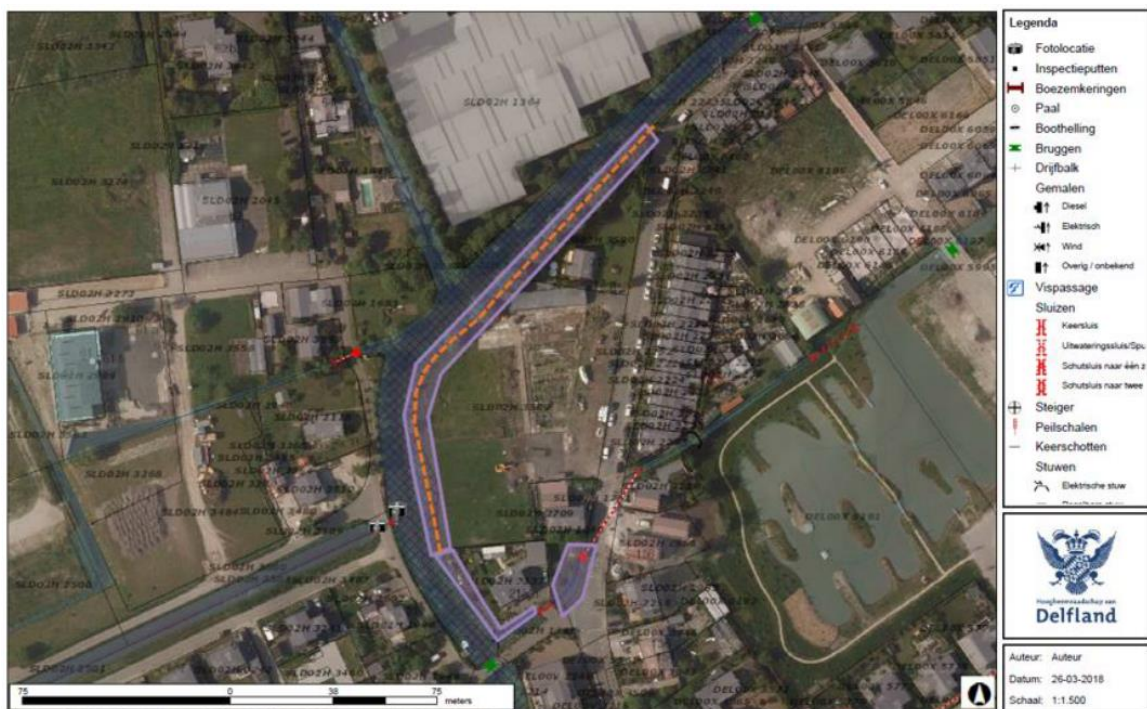
Afbeelding 2.2 Indicatie van het projectgebied (paars) met aanduiding van de ligging van de aan te leggen waterkering (oranje stippellijn)
