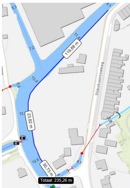
Afbeelding 2.1 Traject waarover variant kadeverlegging wordt gerealiseerd
