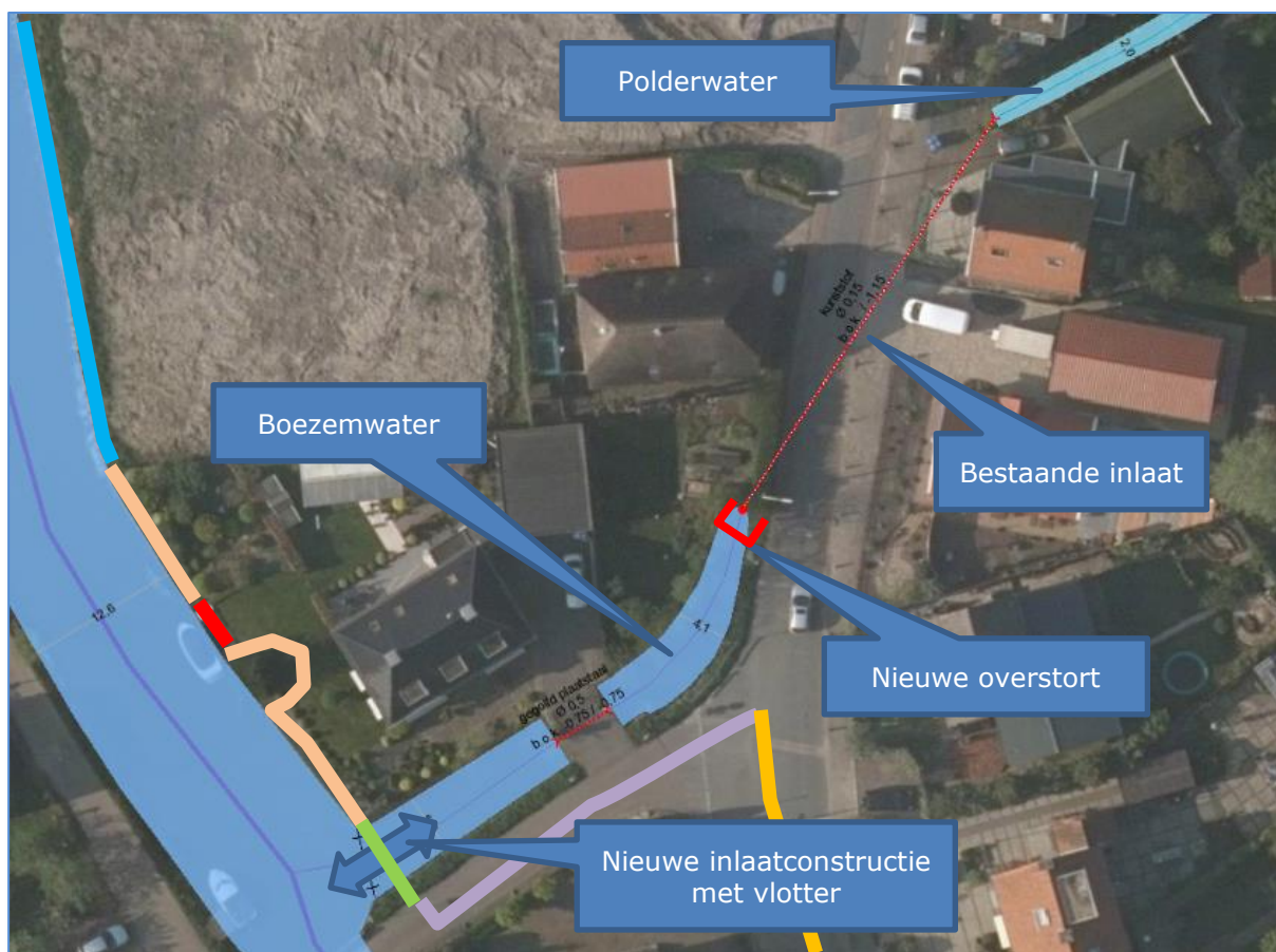
Werking wateraan- en afvoer boezemtak
