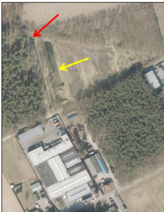
Plangebied en ten noorden daarvan gelegen perceel met de greppel voor opvang van hemelwater (rode pijl), de vijver ten behoeve van opvang van koel-/spiegelwater (en gele pijl)
