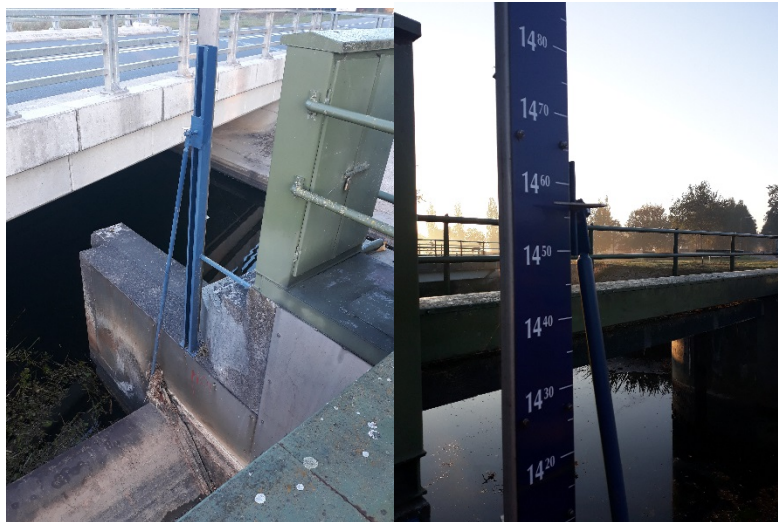
Figuur 4.7 Mechanische aanwezige peilschaal
