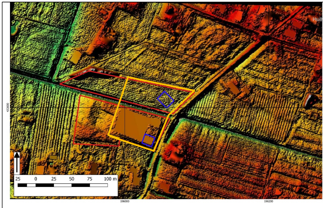
Afbeelding 4: Hoogte van het plangebied en directe omgeving, met het plangebied in de rode kaders en het onderzoeksgebied binnen het oranje kader. De bouwkvavels bevinden zich binnen de blauwe kaders (bron: https://ahn.arcgisonline.nl/ahnviewer/ )
