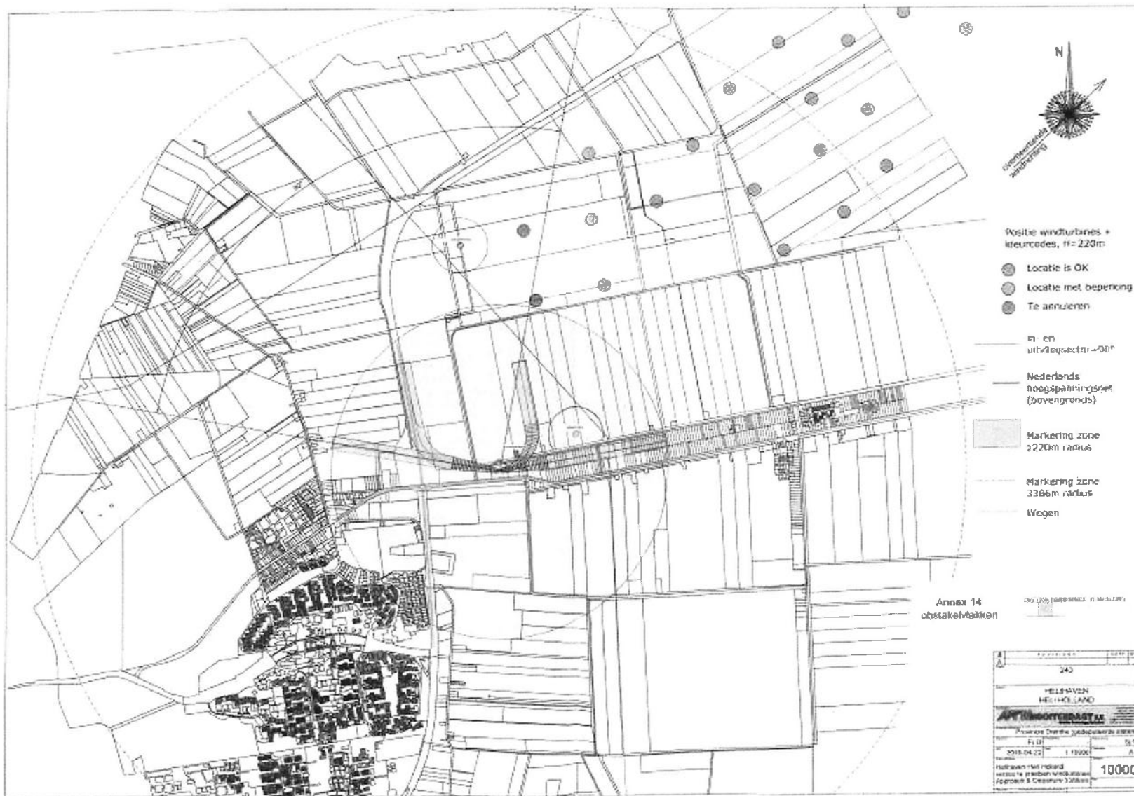
Figuur 3 Overzicht ligging gewijzigde obstakelvrije vlakken rondom helihaven Emmer-Compascuum o.b.v. ICAO Annex 14 volume II (Heliports), 4th edition 2013. De locaties van de windturbines zijn indicatief.
