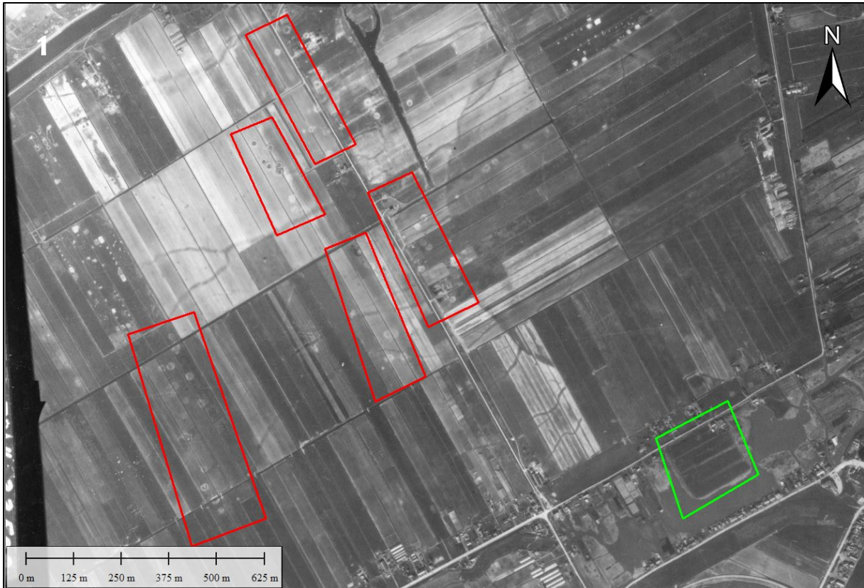
Figuur 19. Binnen de rode kaders op deze luchtfoto van 13 april 1945 zijn meerdere kraters van afwerpmunitie zichtbaar. Luchtfotonummer 3067.
