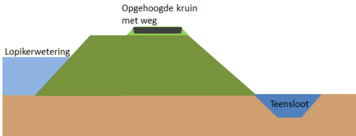
Figuur 9: Schets van het ophogen van de kruin van de waterkering.
