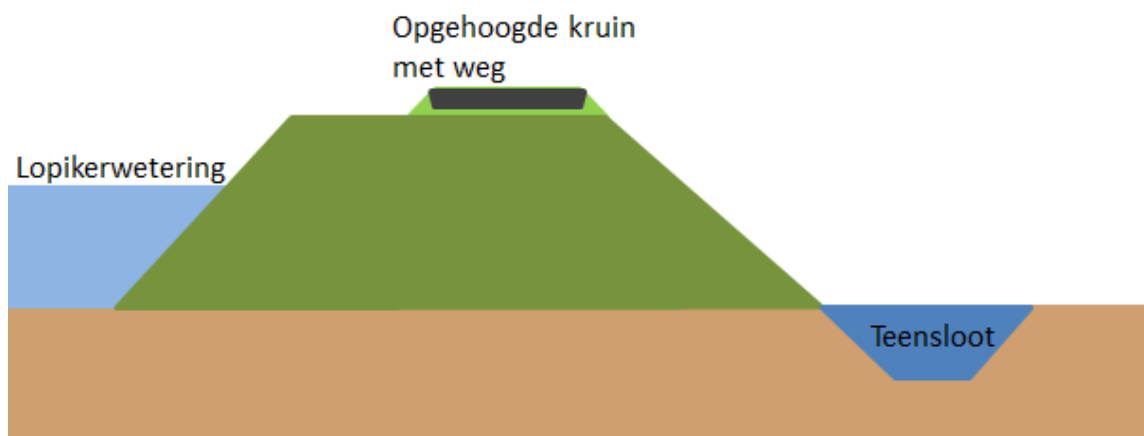
Figuur 74: Schets van het ophogen van de kruin.
