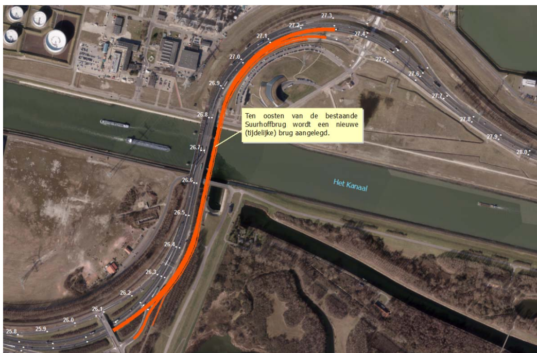
Figuur 4.1 Situatietekening (tijdelijke) brug
