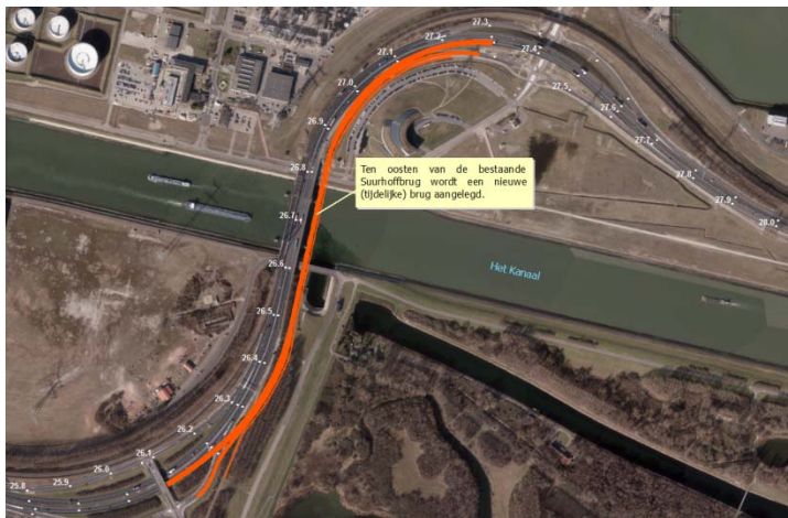
Figuur 3.1: Situatietekening (tijdelijke) verbinding Suurhoffbrug
