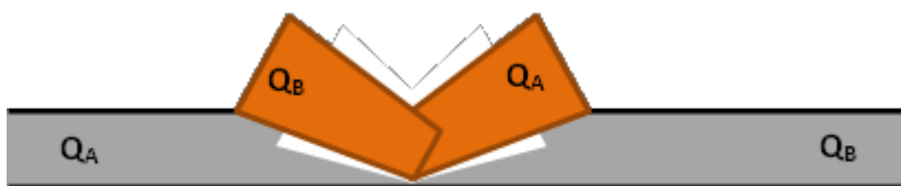
Figuur 34 Aantal jets en bijdragen vanuit stroomopwaartse en stroomafwaartse leidingdelen voor breuk van een bovengrondse leiding
