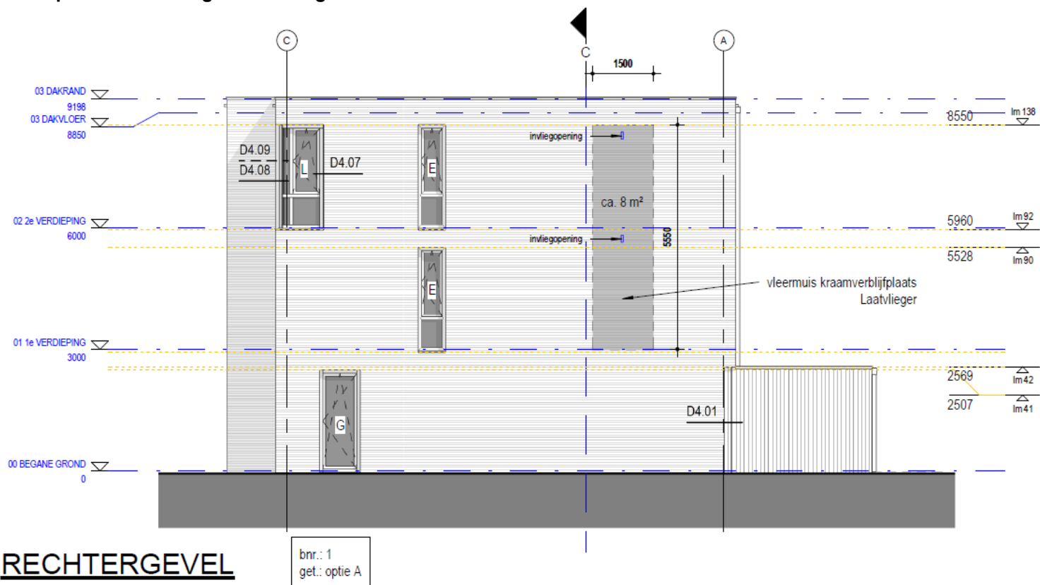
Figuur 6. Locaties permanente mitigatie laatvlieger in de rechtergevel van blok 1, bestaande uit 1 maatwerk kraamverblijfplaatsen.
