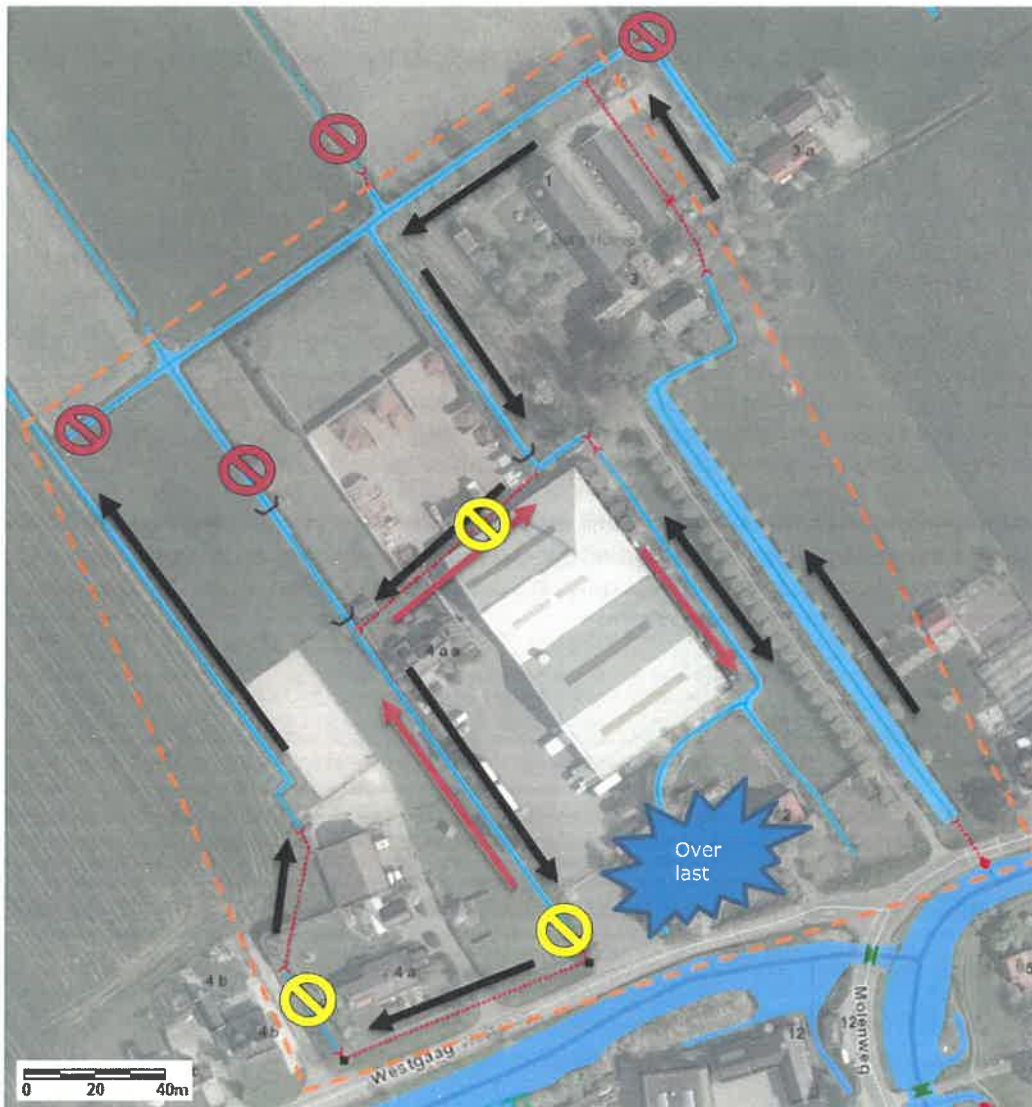
Figuur 2: Huidige situatie watersysteem bij normale situatie (zwarte pijlen), waarbij de rode cirkels de doodlopende routes aangeven. Bij een piekbui ontstaan er opstoppingen bij de gele knelpunten, waardoor de waterstroom terugloopt naar het doodlopende watergang ter hoogte van Westgaag 4 (rode pijlen)
