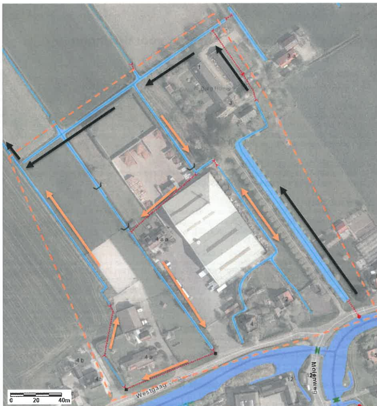
Figuur 5: Waterstromen in het nieuwe watersysteem. Zwart: Hoofdstroom, Oranje: Substream in normale situatie.
