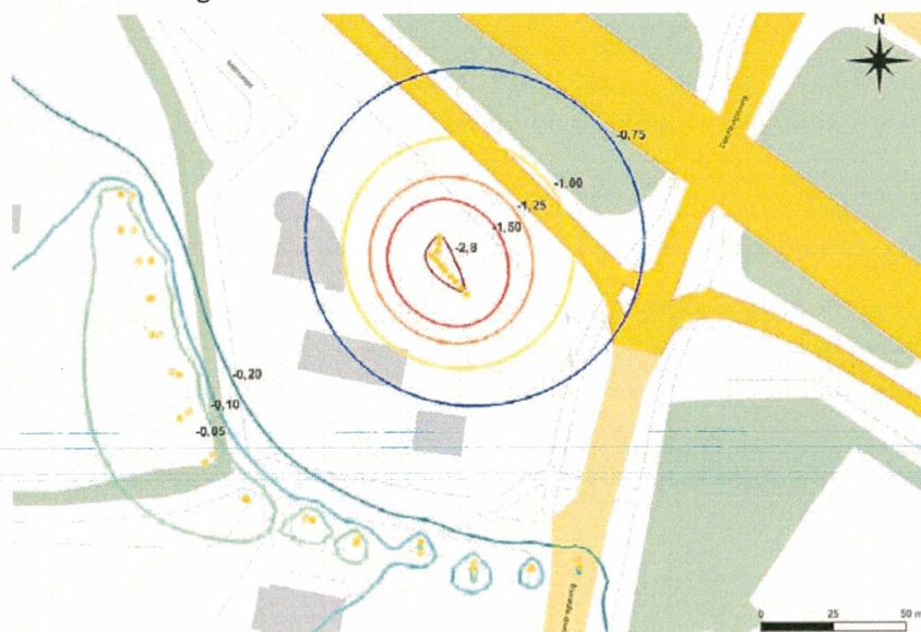
Figuur 12: Verlagingscontouren bemaling kruising K001R
