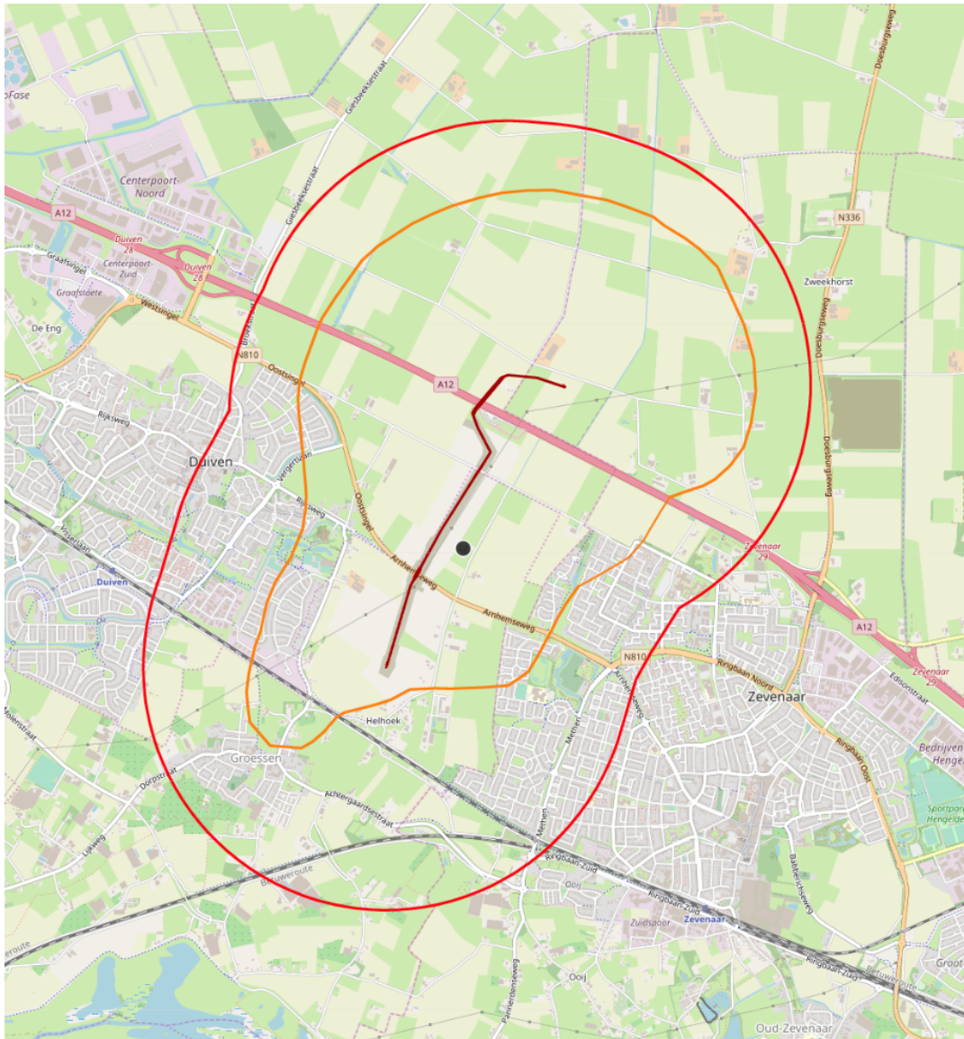
Afbeelding 10: Theoretische invloed (rood) t.o.v. werkelijke invloed bemaling (oranje)
