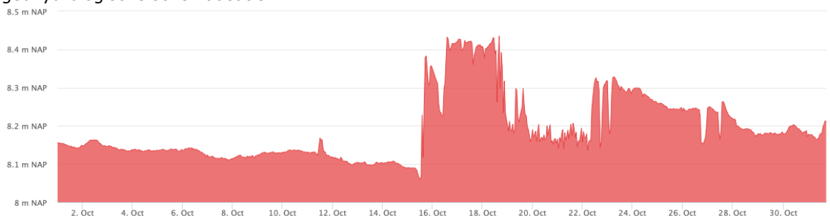
Afbeelding 3: Effect retourbemaling tijdens proefbemaling Gasunie.
