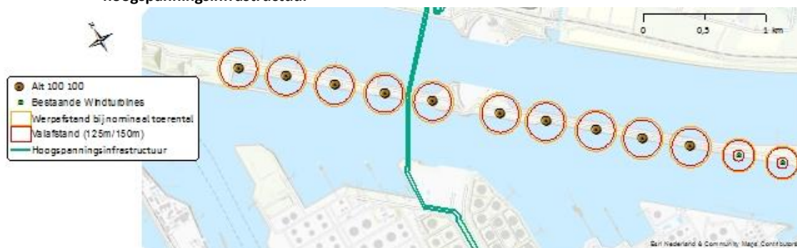
Figuur 18 Werpafstand bij nominaal toerental en valafstand van de windturbines en hoogspanningsinfrastructuur
