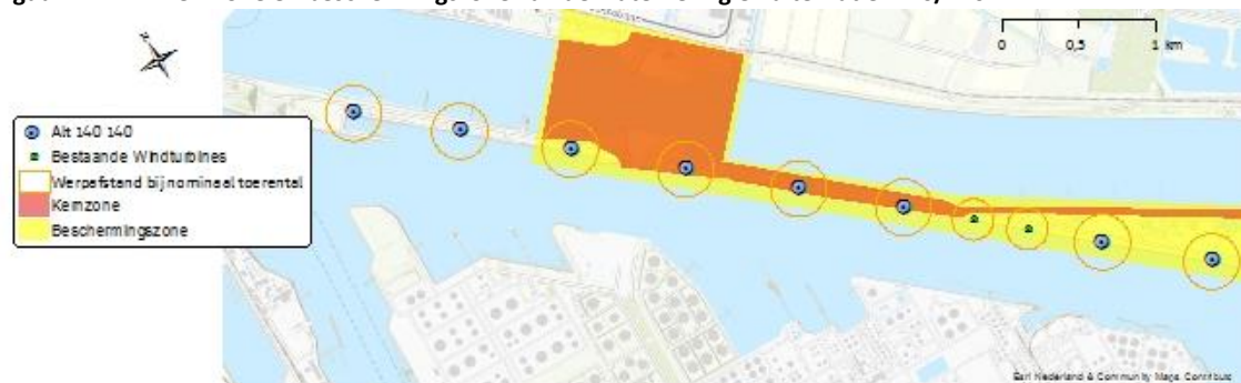
Figuur 24 Kernzone en beschermingszone van de waterkering en alternatief 140/140
