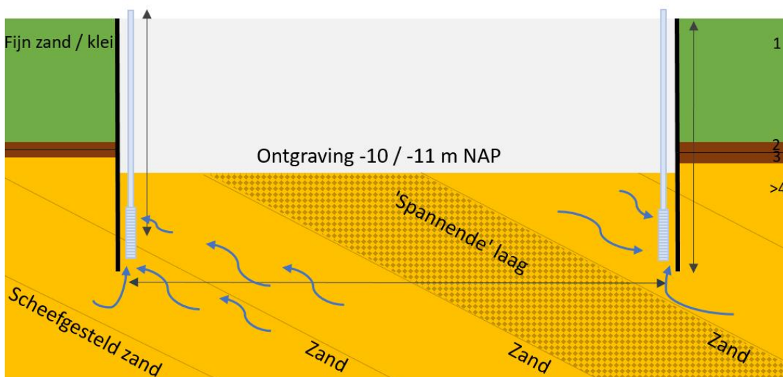
Figuur 8. Situatieschets 3: Sportlaan inclusief anisotropie en bemaling aan de binnenzijde. De damwanden worden aangebracht op verschillende niveaus. Het niveau neemt toe richting het midden van de bouwkuip. De bronnen komen aan de uiteinden onder het damwandniveau uit. De 'spannende' laag is een laag die mogelijk o.i.v. de locatie van de bronnen niet bemalen wordt. Dit is een resultaat van anisotropie. Het niet kunnen droogleggen van deze laag dient ten alle tijde voorkomen te worden.
