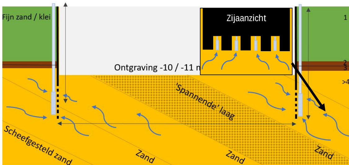
Figuur 7. Situatieschets 2: Kronenburg en Zonnestein inclusief anisotropie en bemaling aan de buitenzijde. De damwanden worden eerst lokaal gestaffeld aangebracht, de bronnen staan tussen de kortere damwanden, dit is afgebeeld in zwart omrand figuur. De bronnen (lichtblauw) worden t.h.v. de kortere damwanden (zwarte blokken) geplaatst. De 'spannende' laag is een laag die mogelijk o.i.v. de locatie van de bronnen niet bemalen wordt. Dit is een resultaat van anisotropie. Het niet kunnen droogleggen van deze laag dient ten alle tijde voorkomen te worden. Opgemerkt wordt dat de h.o.h. afstand tussen de bronnen groter is dan in de schets weergegeven.
