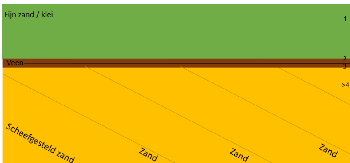
Figuur 6. Basismodel 1: de lagen zijn aangegeven middels nummers. De veenlaag is opgedeeld in twee modellagen. Let op: nummering lagen komt niet overeen met de bodemopbouw in tabel hoofdstuk 5.
