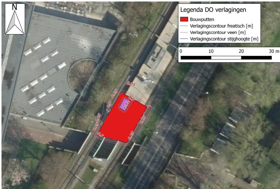
Figuur 35. Verlagscontour (Veen) halte Meent. In rood: bouwput en in paars: liftput
