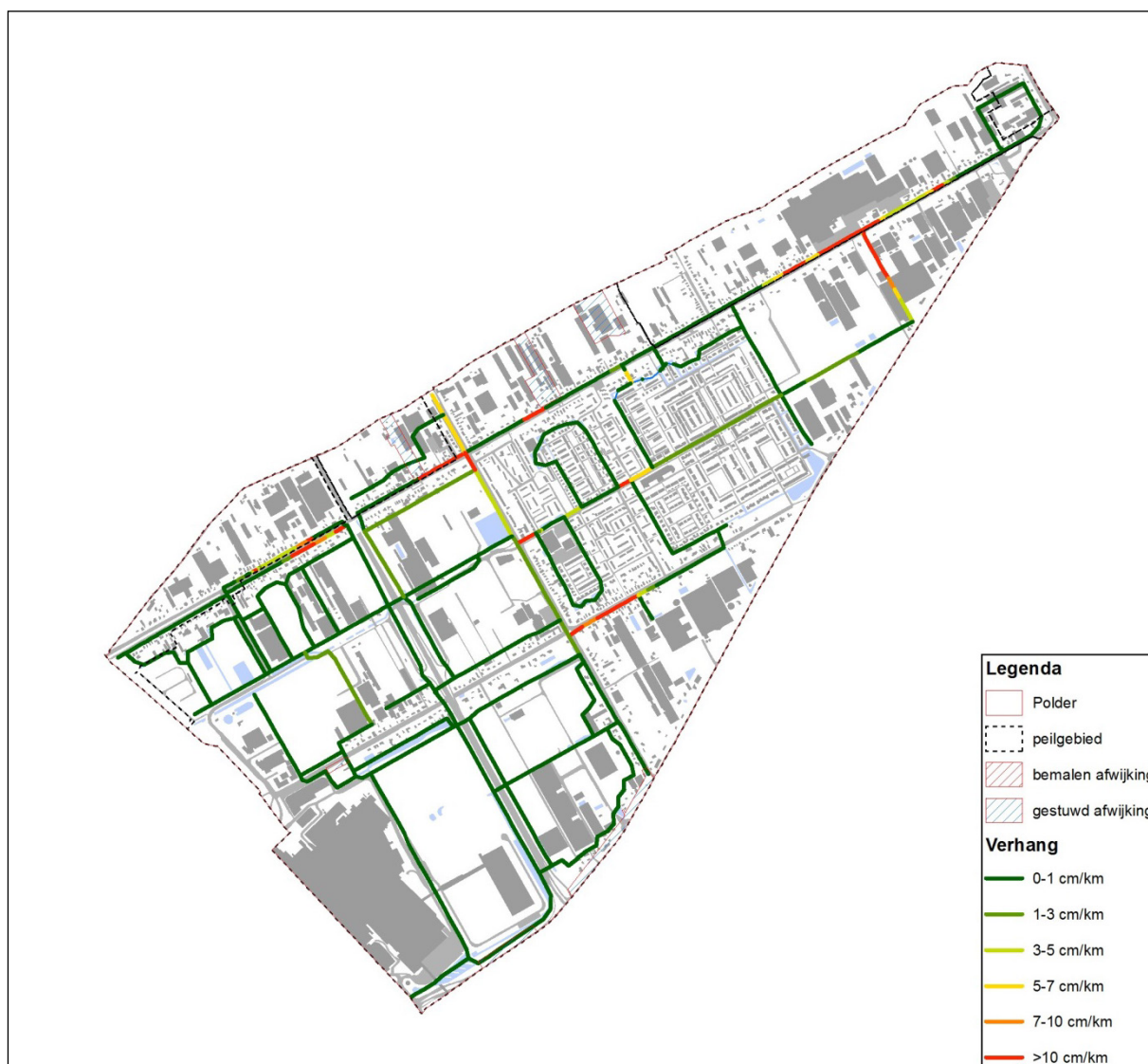
Figuur 4.1 Berekend verhang in watergangen bij normafvoer
