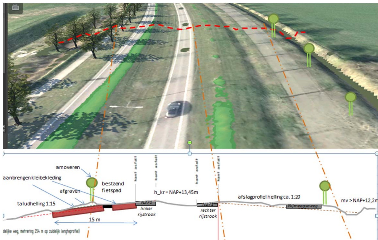
Figuur 6: 3D figuur en dwarsprofiel ter plaatse van laagste punt overlaat (groen gearceerde is hoger dan NAP+ 13,45m), zie ook bijlage 3
