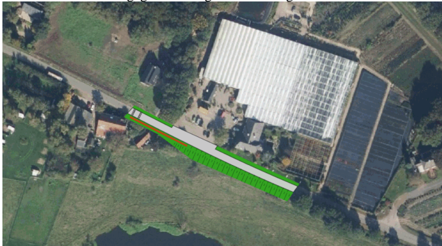
Figuur 6-2: Alternatief 2. (De damwand zit deels ondergronds).
