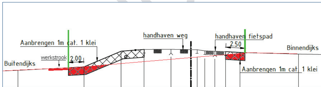
Figuur 3. Principeddoorsnede van het aanbrengen van een kleidek en de wijze waarop dit van versturend (rood) kan zijn op het archeologisch niveau (rode lijn).
