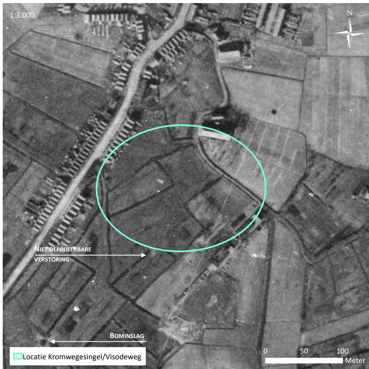
Figuur 24: Het onderzoeksgebied op luchtfotoframenummer 611, sortie H-713 daterende van 10 maart 1941. Op ca. 180 meter afstand van het onderzoeksgebied is een bomkrater zichtbaar.
