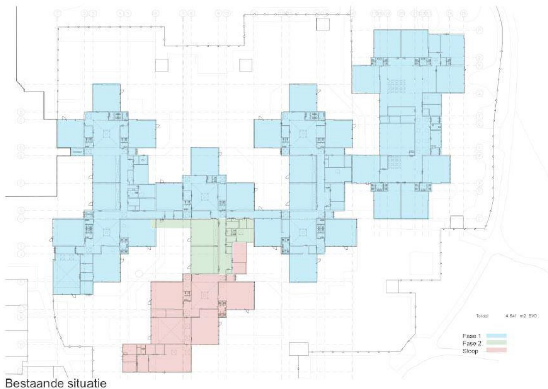
Figuur 2: Fasering van de werkzaamheden. Het rode gedeelte wordt gesloopt en he groene gedeelte wordt gerenoveerd.
