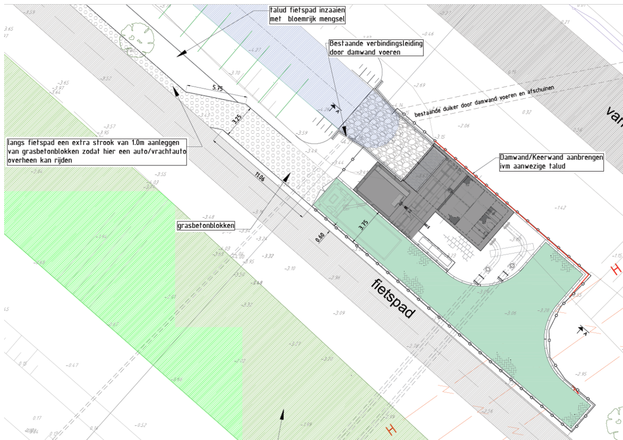
Figuur 2: Detailtekening gemaalterrein en inrit
