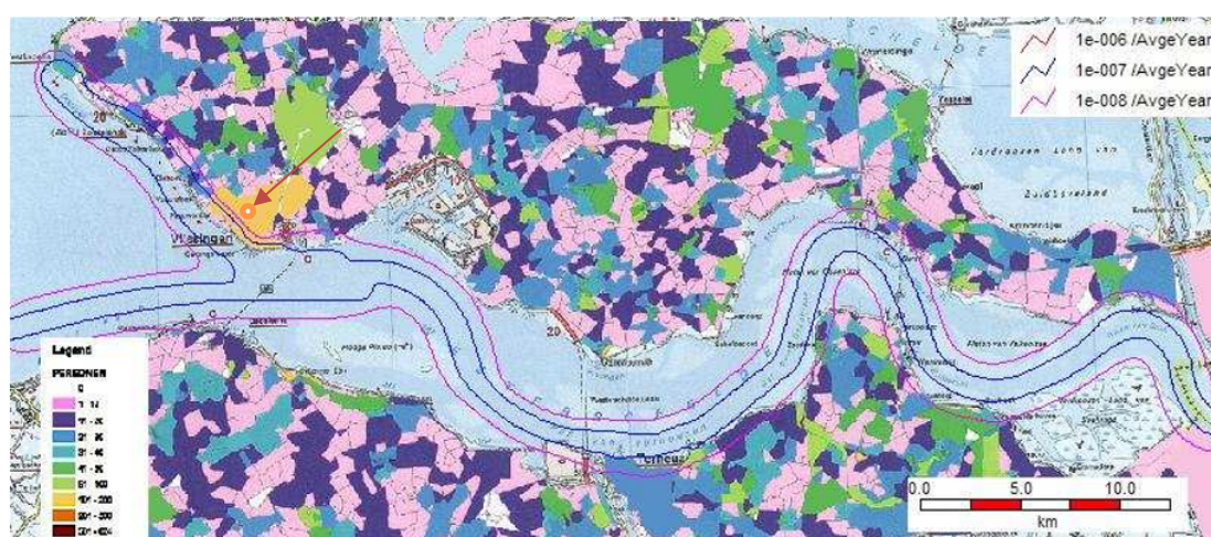
Afbeelding 9 Plaatsgebonden risicocontouren voor de Westerschelde voor het prognosejaar 2030
