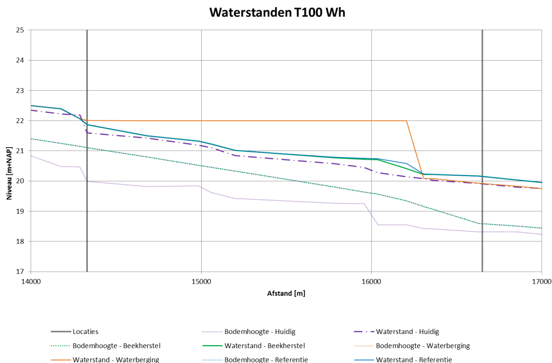
Figuur 4-5 Lengteprofiel berekende waterstanden T100Wh waterbergingsgebied
