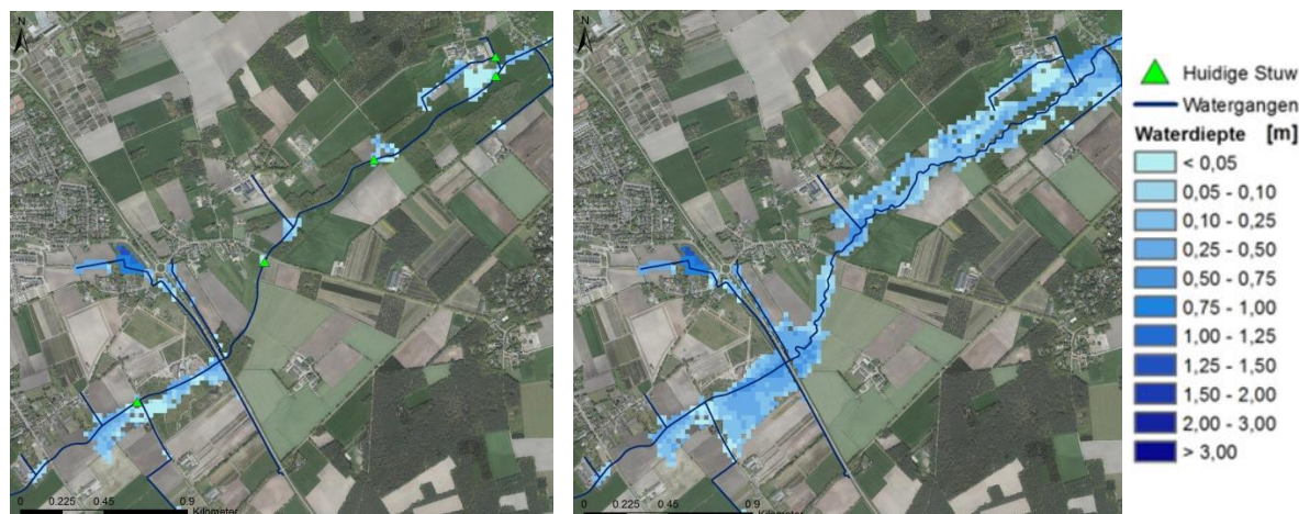
Figuur 3-15 Inundatiebeeld bovenstrooms T10Wh huidig (links) en T10Wh Beekherstel (rechts)
