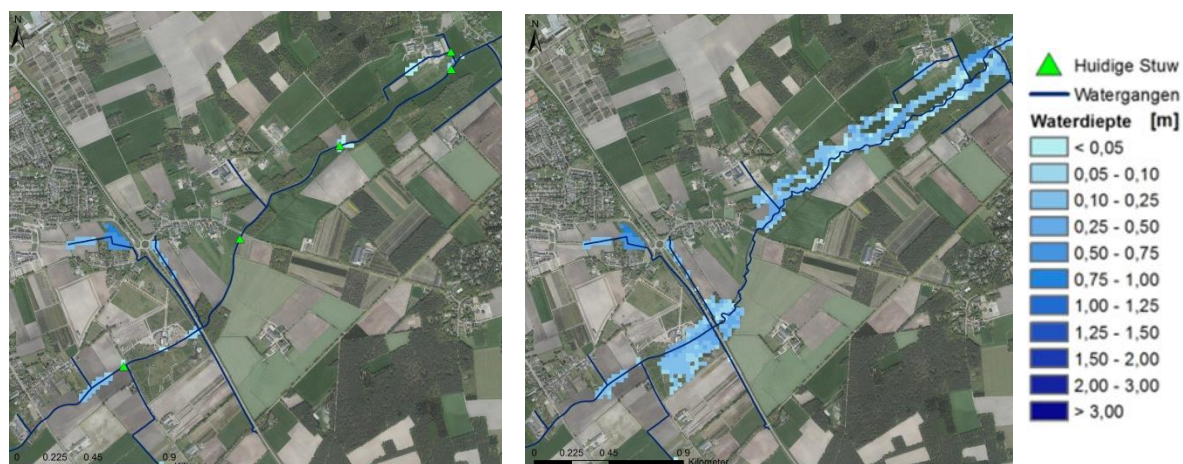
Figuur 3-14 Inundatiebeeld bovenstrooms T1Wh huidig (links) en T1Wh Beekherstel (rechts)
