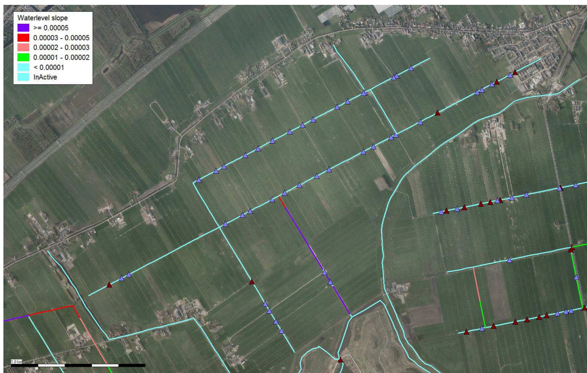
Figuur 4.7: Berekend verhang in primaire watergangen (winter)
