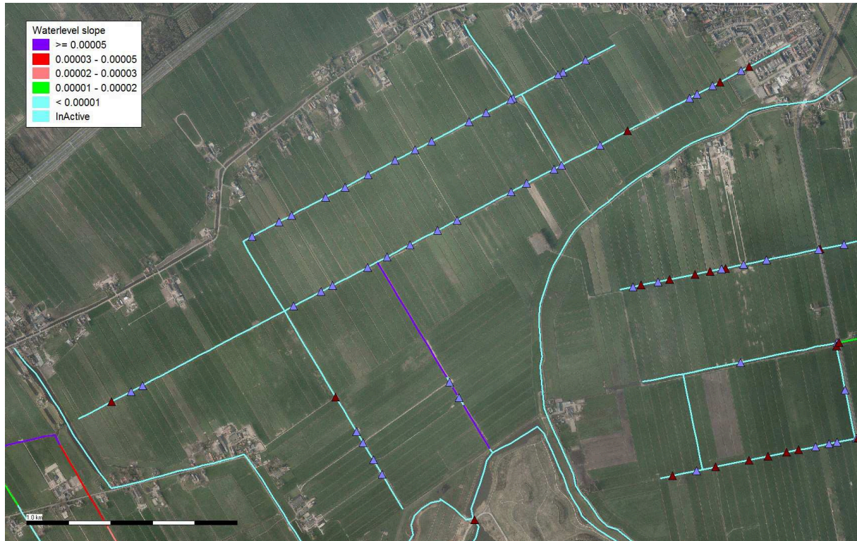
Figuur 4.6: Berekend verhang in primaire watergangen (zomer)
