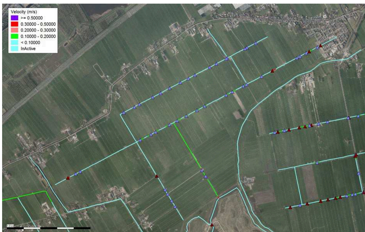
Figuur 4.8: Berekende stroomsnelheid in primaire watergangen
