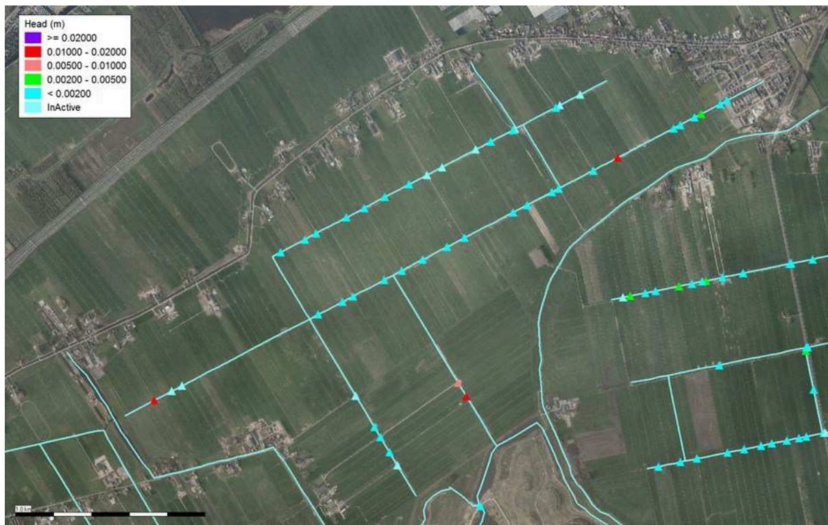
Figuur 4.9: Berekende opstuwing kunstwerken
