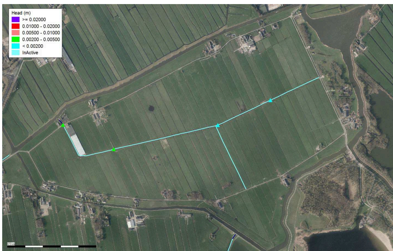
Figuur 4-6 Berekende opstuwing bruggen in primaire watergangen
