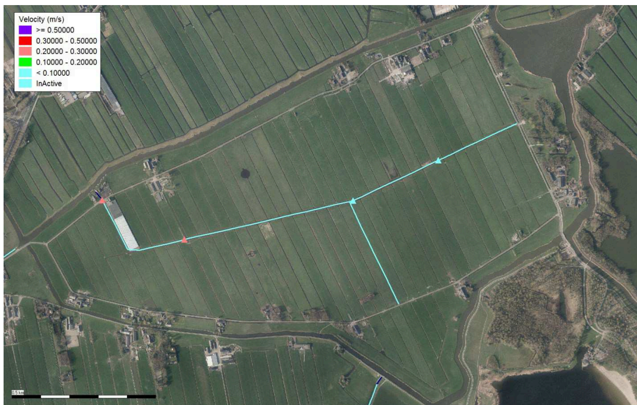
Figuur 4-5 Berekende stroomsnelheid bruggen in primaire watergangen
