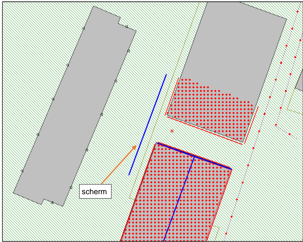
Figuur 5.3: Situering scherm met een hoogte van 4,75 meter boven plaatselijk maaiveld
