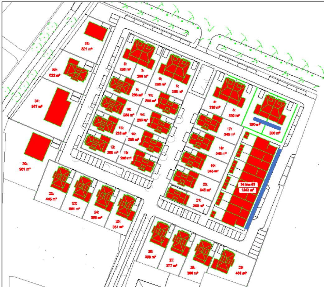
Figuur 5.2: Gevels van de woningen waar de richtwaarde uit de VNG-publicatie en de normstelling uit het Activiteitenbesluit niet wordt gerespecteerd voor het maximaal geluidniveau (rood)
