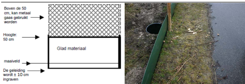
Figuur 2.1 Voorbeelden van (de opbouw van) een amfibieëscherm (NB: i.t.t. het figuur rechts worden in plaats van emmers zandhopen gemaakt tot aan de rand van het amfibieëscherm)
