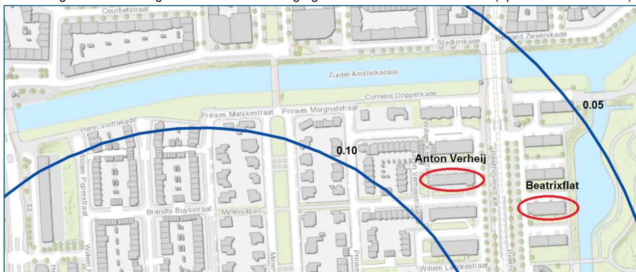
Afbeelding 5. Berekende grondwaterstandsverlagingen met onbehandelde sloten (open damwandsloten)
