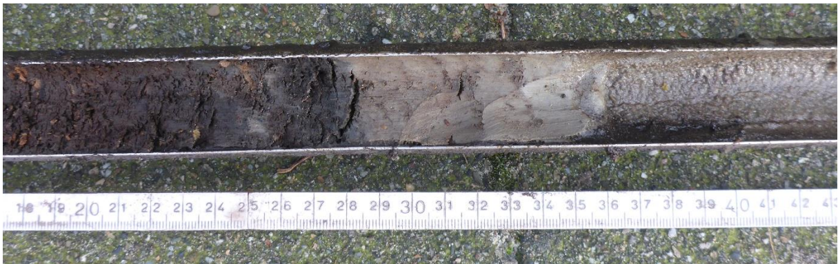
Kleilaag tussen veen en strandzand (boring 12).
