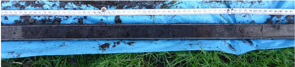
Opgebracht zand op veen (scherpe overgang links) op strandzand (geleidelijke overgang rechts).
