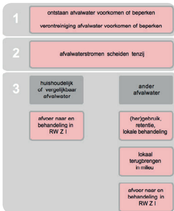
Figuur 3-5: Voorkeursvolgorde omgang met afvalwater
