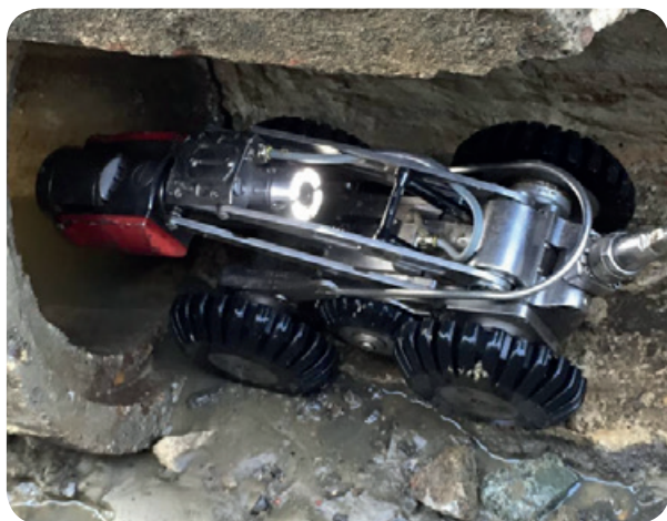
Figuur 5-1: Rioolinspectiecamera (bron: rioolinspectie.nl)
