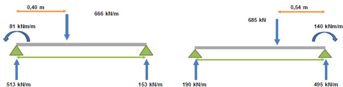
Figuur 1: Bepaling zwaartepunt resultante verticale kracht per maatgevende situatie
