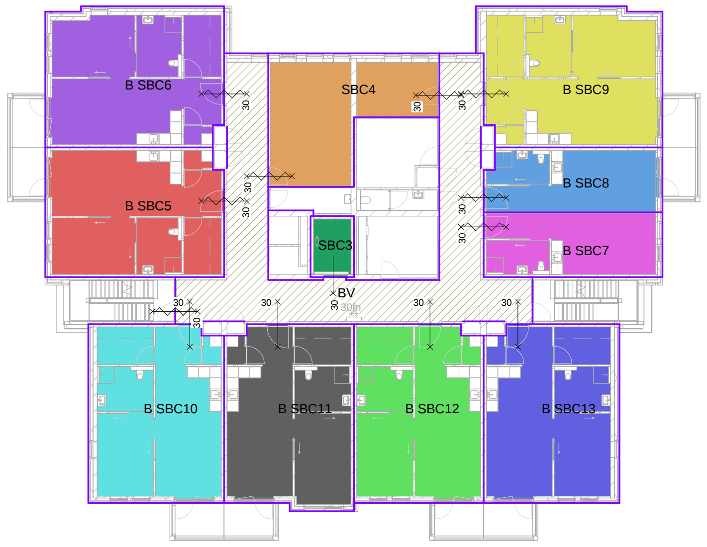
1e Verdieping - Sub-brandcompartimenten
