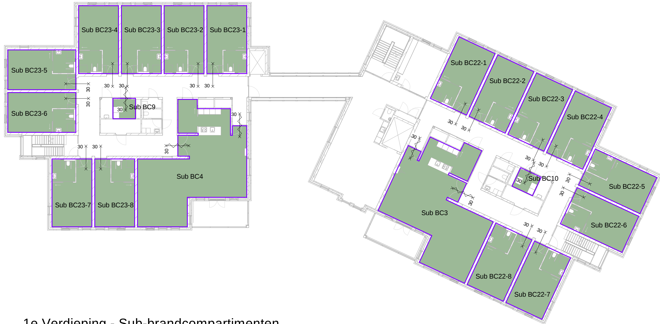
1e Verdieping - Sub-brandcompartimenten
