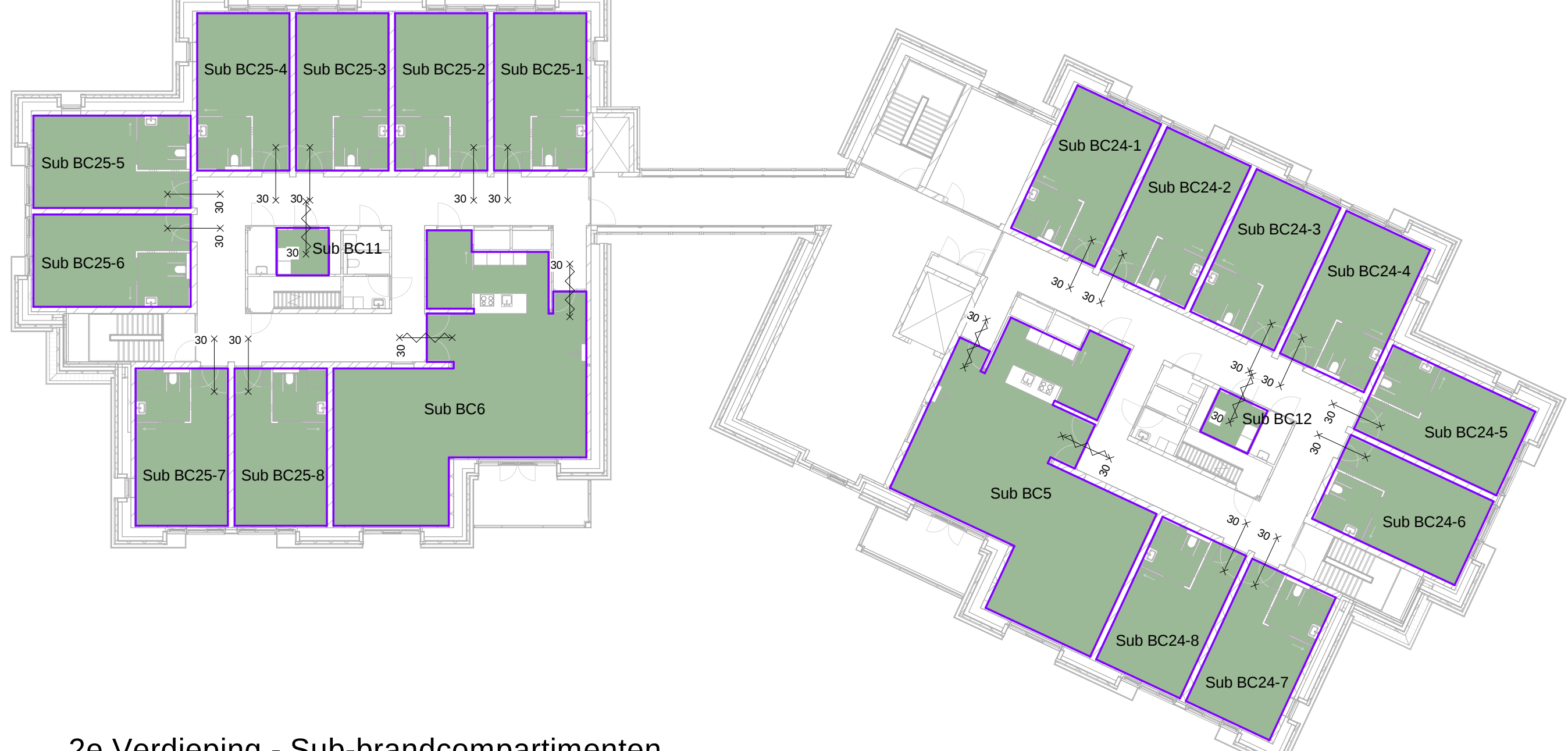
2e Verdieping - Sub-brandcompartimenten
