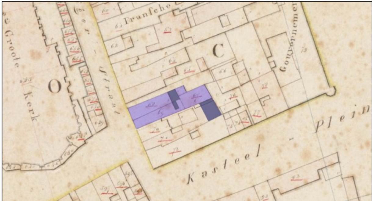
Afb. 4: Uitsnede uit de kadastrale minuutkaart, die de situatie rond 1824 weergeeft (met het noorden rechts). De ingekleurde contour geeft de plek van de anno 2017 bestaande bebouwing van Reigerstraat 8, 10 en 10 B weer. De donkere paarse kleur geeft daarbij aan waar na vervaardiging van deze eerste kadasterkaart bouwdelen zijn toegevoegd, veelal in voormalige buitenruimte. [RCE / auteur]
